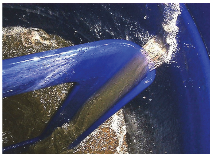
写真2 2 m 3 用グラスライニング製桶型ウォールウェッター
