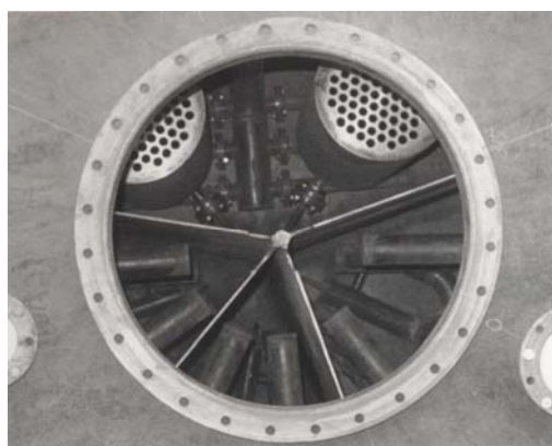
図2 蒸発缶上部から見た多室構造
